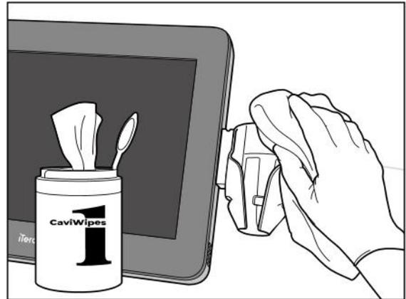
Figura 208: Pulitura della base iTerio Element 2 Plus in configurazione mobile
